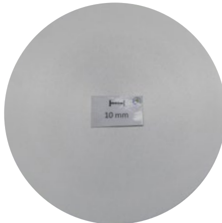
Makroschliff, d178 mm: Seigerungszone 3,1 mm
