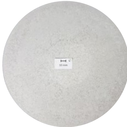
Makroschliff, d278 mm: Seigerungszone 2,1 mm
