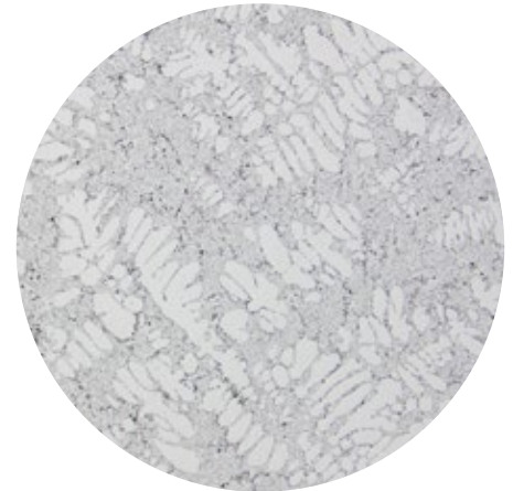
Mikroschliff, d278 mm (25 fache Vergrößerung)
