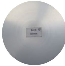
Makroschliff, d178 mm: Seigerungszone 2,7 mm
