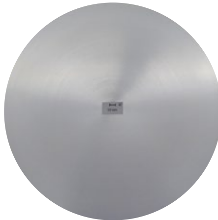
Makroschliff, d424 mm: Seigerungszone 8 mm
