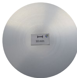
Sezione micrografica d178mm: Area di segregazione 2,7 mm
