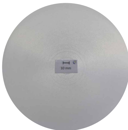
Coupe macro, d252 mm: zone de ségrégation 5,5 mm
