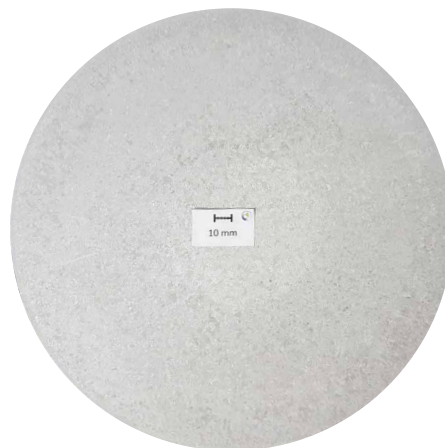
Coupe macro, d278 mm: zone de ségrégation 2,1 mm
