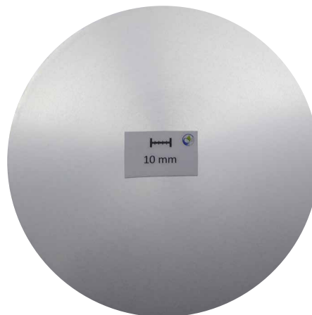
Coupe macro, d178 mm: zone de ségrégation 2,1 mm
