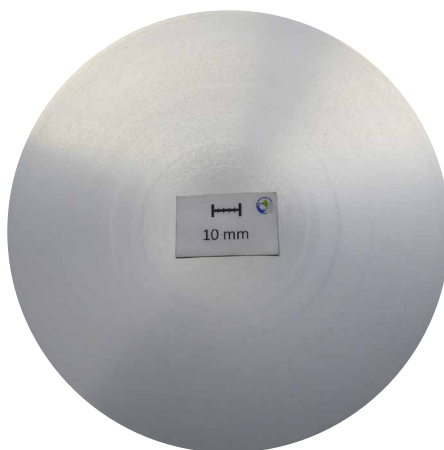
Coupe macro, d178 mm: zone de ségrégation 2,7 mm
