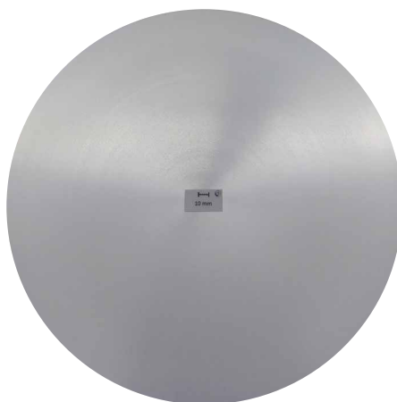
Coupe macro, d424 mm: zone de ségrégation 8 mm
