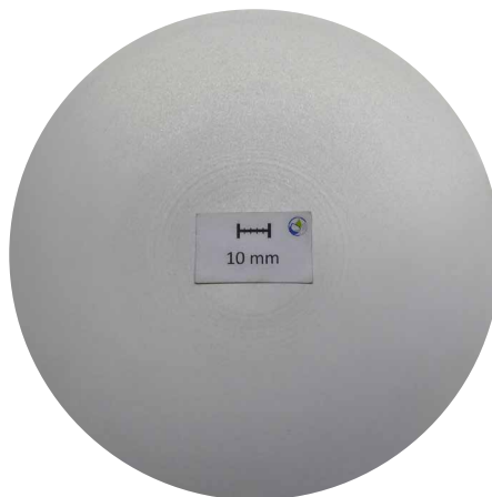
Coupe macro, d177 mm: zone de ségrégation 3,1 mm
