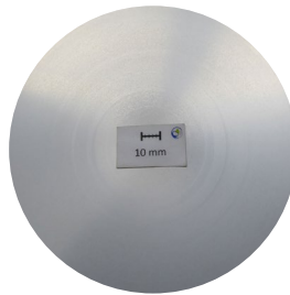
Makroschliff, d178 mm: Seigerungszone 2,7 mm
