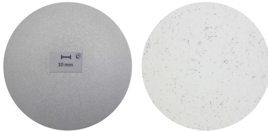
Makroschliff, d159 mm: Seigerungszone 2 mm      Mikroschliff, d159 mm (25 fache Vergrößerung)
